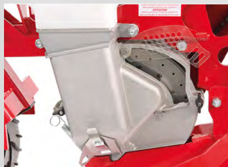
Große Sichtfenster um die richtige Verstellung der Saatmenge zu prüfen
